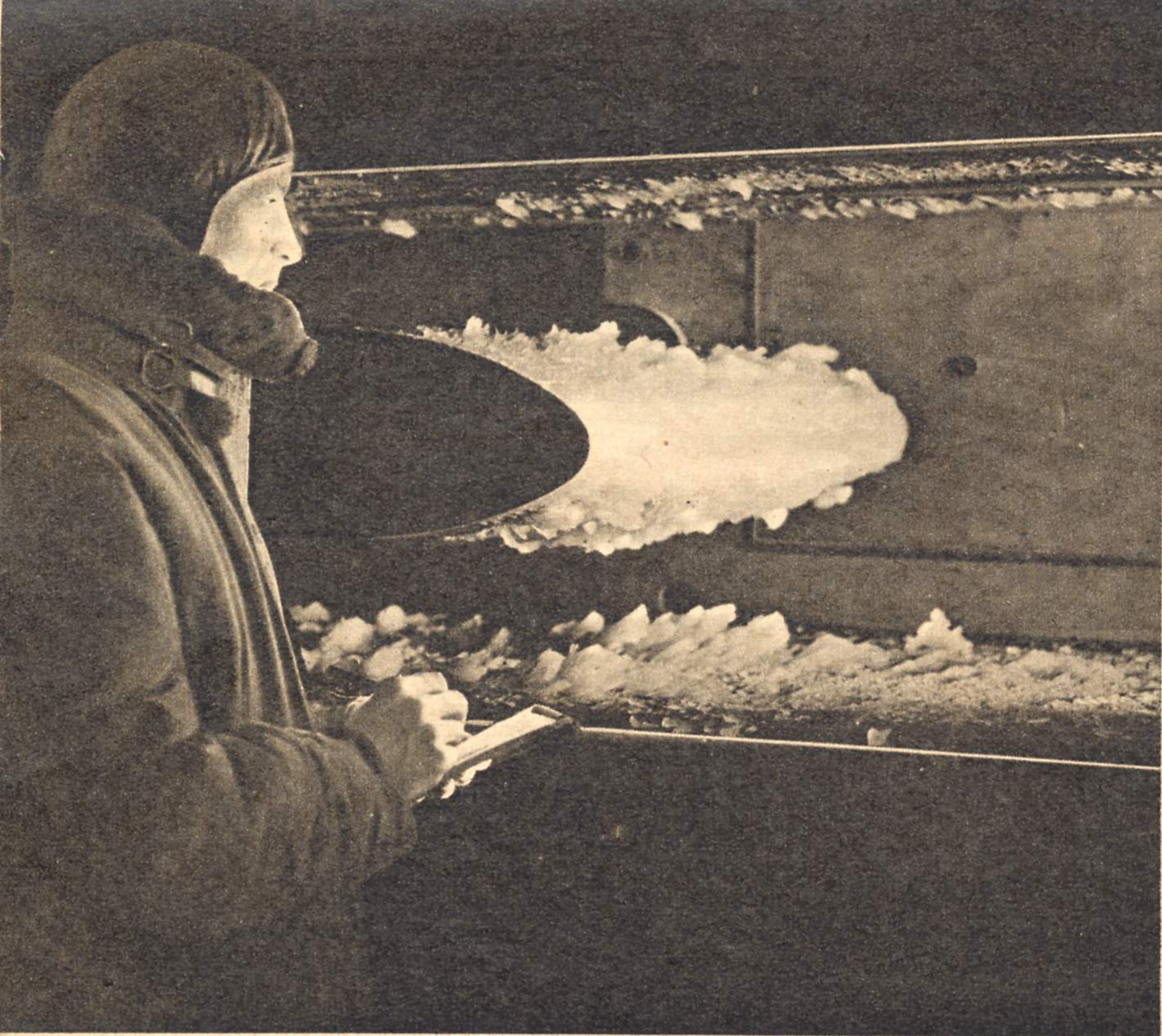
Modell eines Tragflächenprofils im Kältewindkanal der Aerodynamischen Versuchsanstalt Göttingen. Durch eine Glasscheibe können die Vorgänge im Innern des Kanals beobachtet werden. Das Profil ist bereits an seiner Nase mit einer krustigen Eisschicht überzogen
