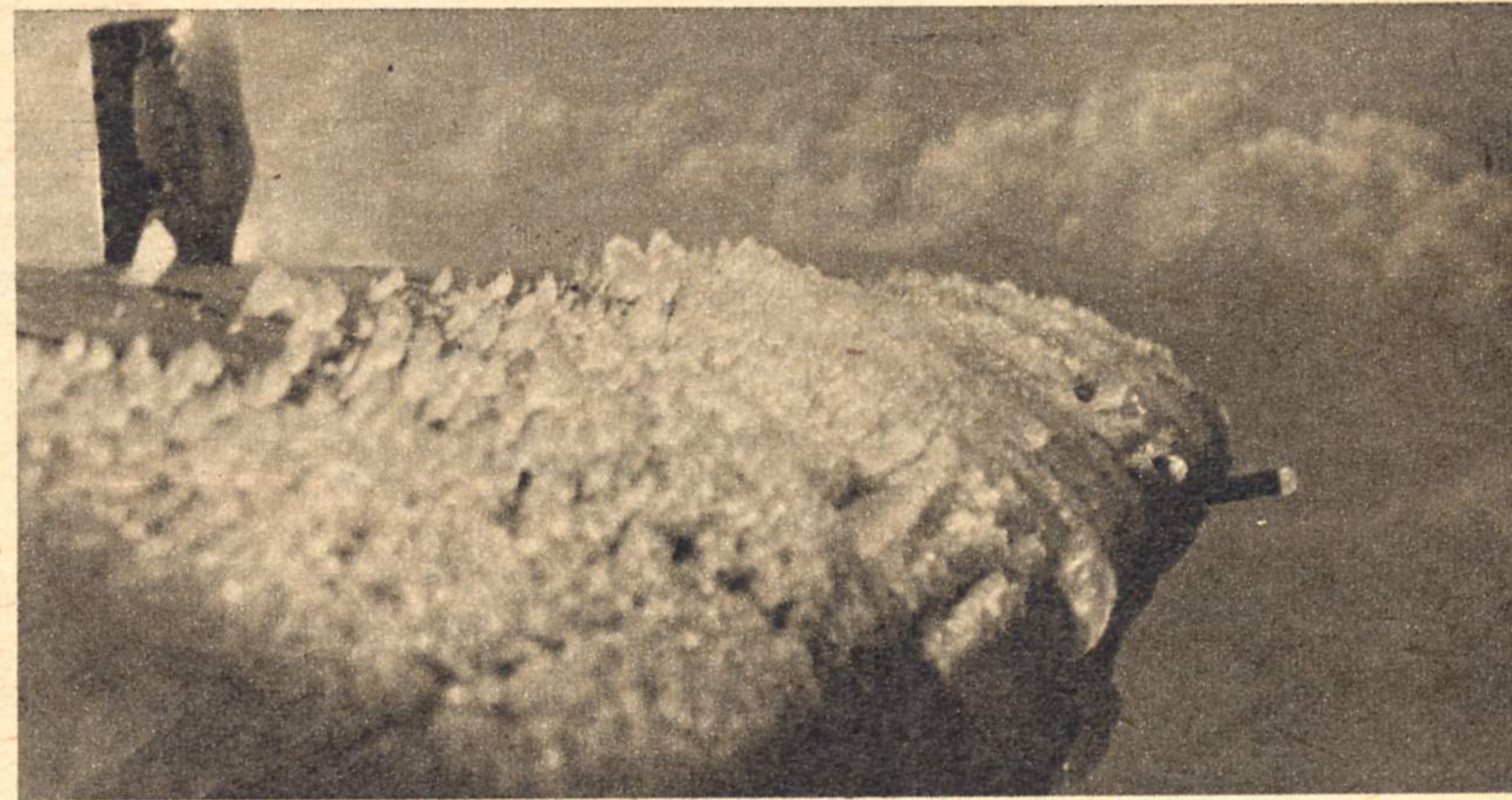
Stark vereister Vorderteil einer Tragfläche im Fluge. Der Eisbelag zeigt eine unregelmäßige und körnige Form
